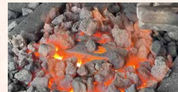
Der Hammer-Rohling liegt im Schmiedefeuher und wird für die Bearbeitung erhitzt.
