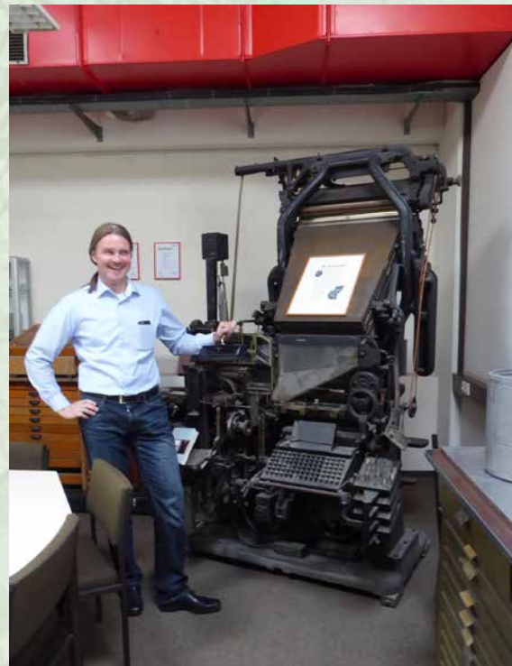
Tielko de Groot erklärt die Funktion einer Zeilenguss-Setzmaschine (Linotype)
